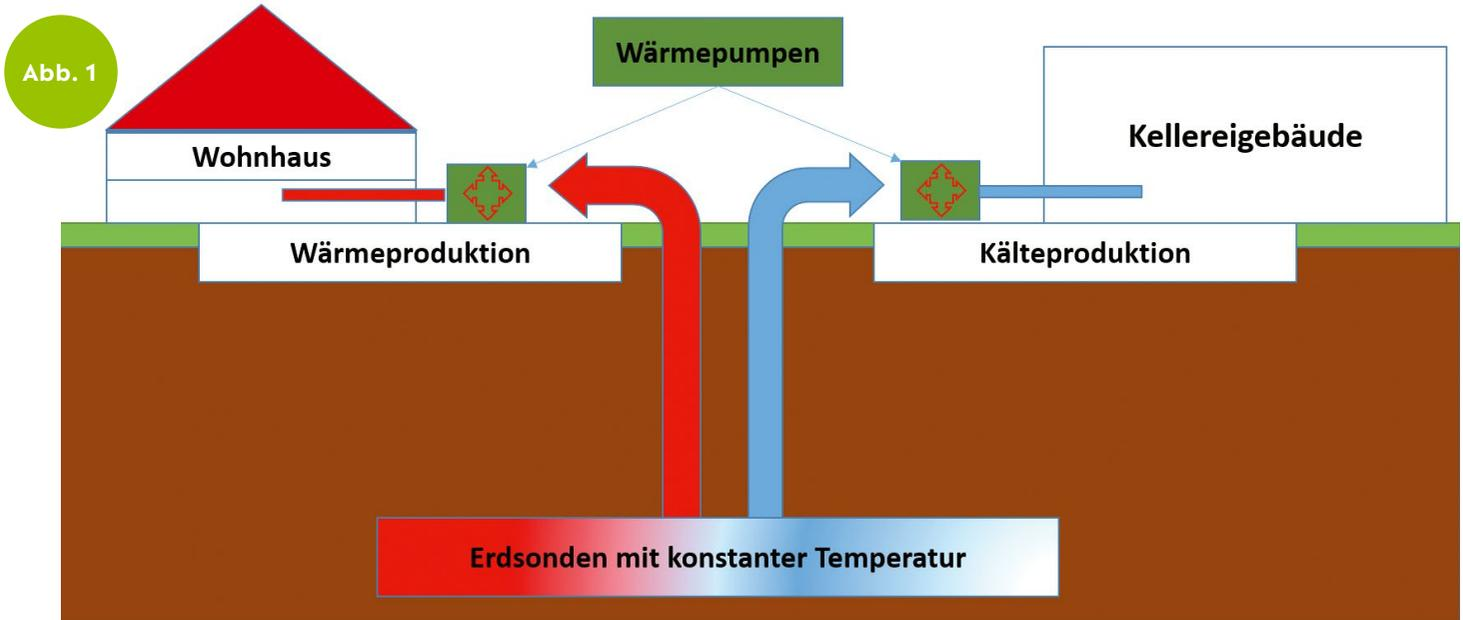
Schematische Darstellung der Nutzung von Geothermie in einem Weinbaubetrieb
